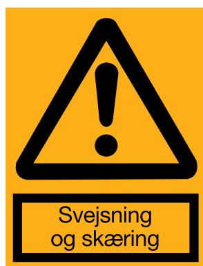
Fig. 25 Advarselsskilt til områder med svejse- og skærearbejde. Området skal desuden være mærket med skilte med rygeforbud
