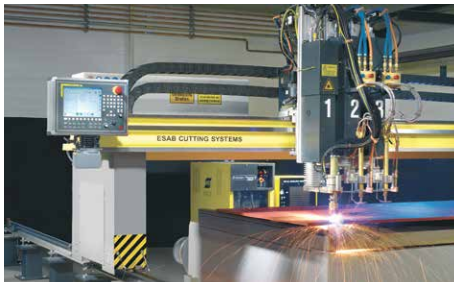
Fig. 11 Eksempel på skærebord med indbygget udsugning i bordet
