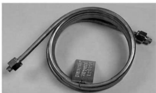
Figur 19.8. Pakket kolonne til GC.
